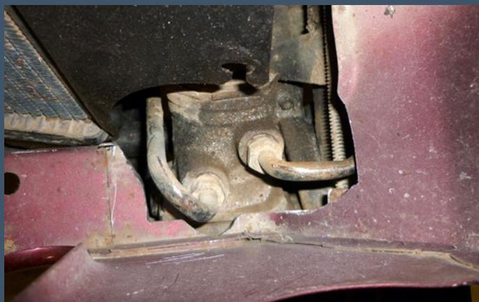
▲ Durch die andere Position des CJ-Grills stößt er am Lenkgetriebe an. Der innenliegende Ausschnitt ist anschließend nicht sichtbar.
