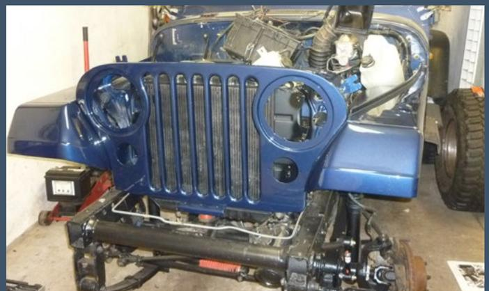
▲ Nach dem Lackieren geht es ans Zusammenbauen. Vorsichtig wird die Front eingepasst, bevor alle Schrauben endgültig festgezogen werden.
