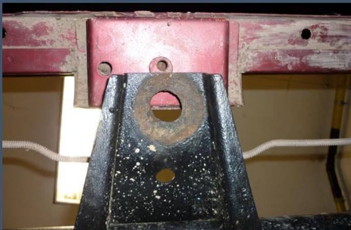
▲ Der Kühlergrill des CJ-7 sitzt im Original weiter hinten. Die Rahmen-Aufnahme des Wrangler ist zu kurz und muss verlängert werden.
