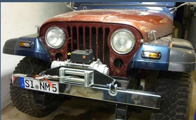
▲ Bei der Anprobe wird die Front ausgerichtet und alle neuen Löcher gebohrt. Nach dem Bearbeiten gehen die Teile dann zum Lackierer.
