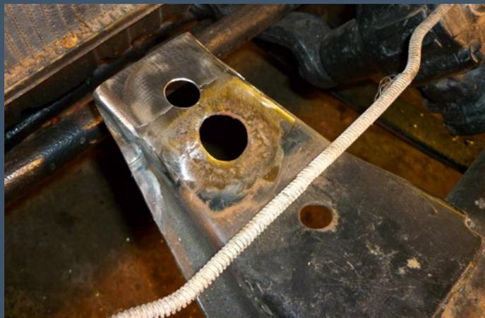
▲ Die Aufnahme wird mit einem gekanteten Blechstreifen verlängert. Nach dem Schweißen wird die Fläche noch einmal glattgeschliffen.
